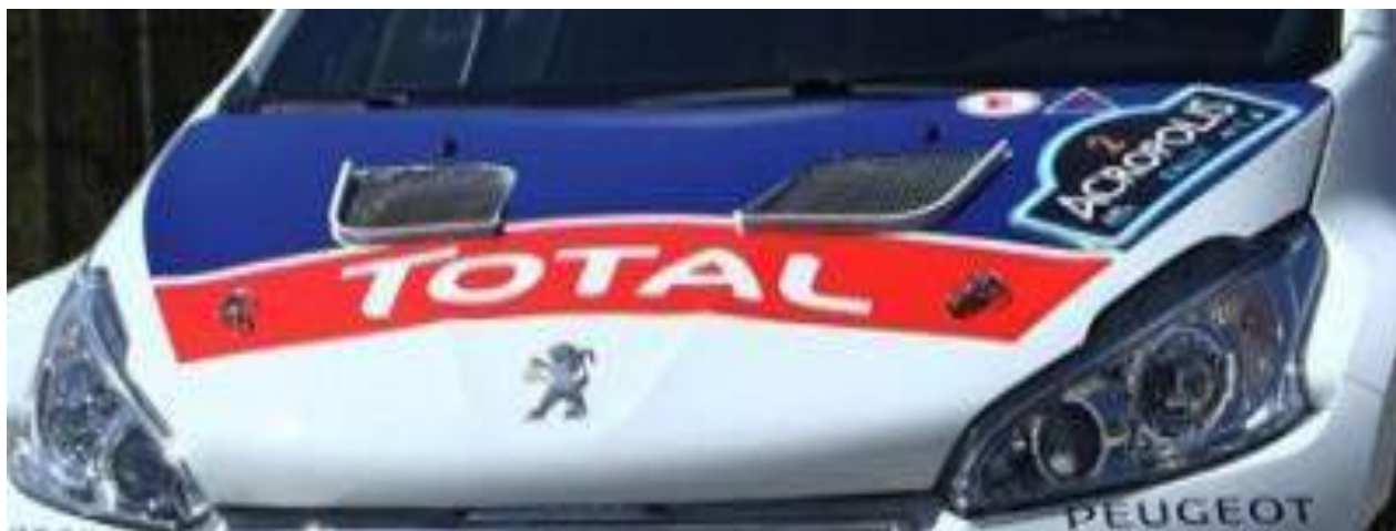
Figura 123: Capó montado, con entradas de aire y cierres metálicos de tipo rally (Imagen tomada de http://www.rallyreportwrc.com/2014/03/29/el-208-t16-r5-domino-en-el-shakedown-griego-con-abbrinq-breen-en-su-estreno-absoluto-en-el-erc/ )
