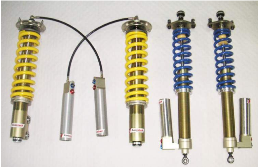
Figura 29: Conjunto de amortiguadores delanteros y traseros de 3 vías (Imagen tomada de http://tecnoshock.com/productos/amortiguadores/dampers.htm )
