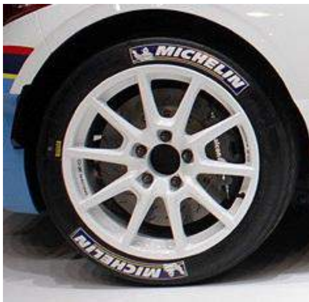
Figura 32: Detalle de una de las ruedas que monta el Peugeot 208 R5 en circuitos de asfalto (18") (Imagen tomada de http://es.autoblog.com/photos/peugeot-208-r5-par-s-2012/1735076/ )
