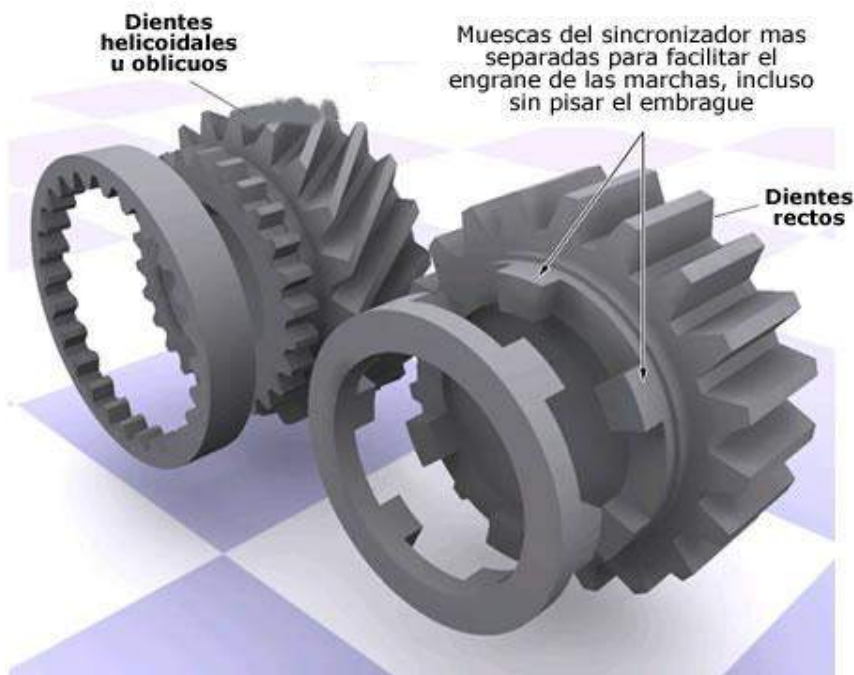
Figura 25: Engranajes de dientes helicoidales y dientes rectos, con sus respectivos elementos sincronizadores (Imagen tomada de http://www.aficionadosalamecanica.net/foro/viewtopic.php?f=12&t=28 )
