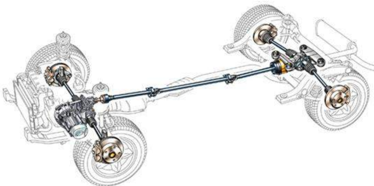
Figura 26: Sistema de transmisión 4x4 con motor transversal y sin diferencial central (Imagen tomada de http://www.goauto.com.au/mellor/mellor.nsf/story2/5484B956E7794A8CCA256A950026A703 )
