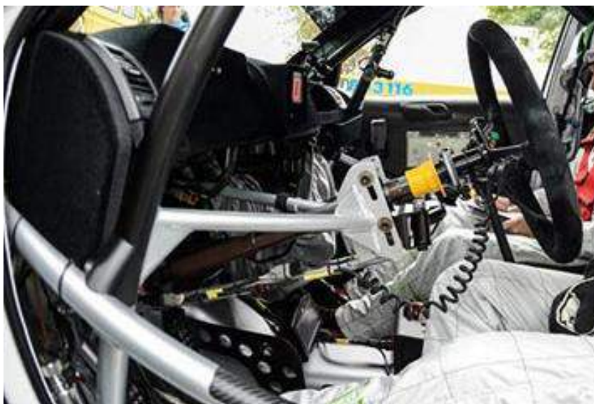
Figura 31: Columna de dirección y volante retrasados respecto a su posición original en un Peugeot 208 R2 (Imagen tomada de http://www.rallyraid.es/2012/10/umberto-scandola-domina-el-shakedown-del-rallye-sanremo-16731 )
