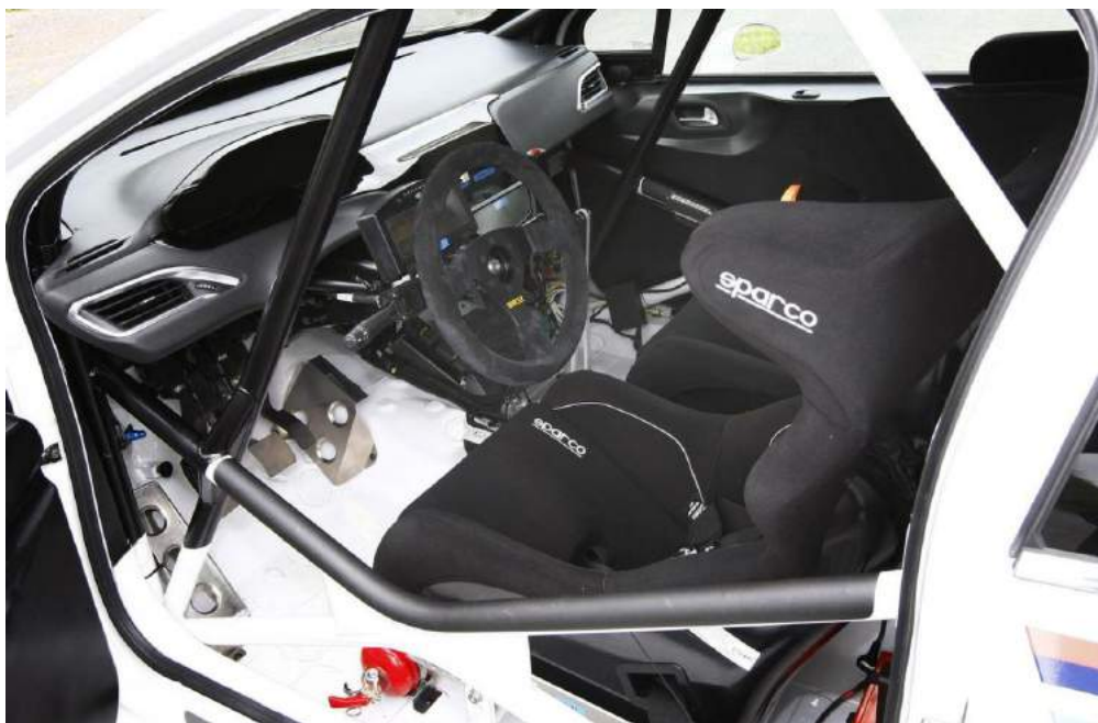
Figura 56: Detalle de la posible ubicación del extintor manual, bajo el asiento del piloto, en un Peugeot 208 R2 (Imagen tomada de http://www.tf1.fr/auto-moto/photo/la-peugeot-208-r2-en-photos-7220785-REIBX05VTUVSTyAxMw==.html#photo/14 )
