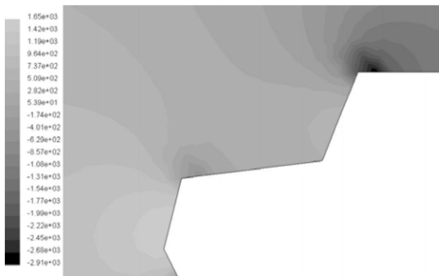
Figura 5. 16 Bajas presiones en morro y parabrisas.
