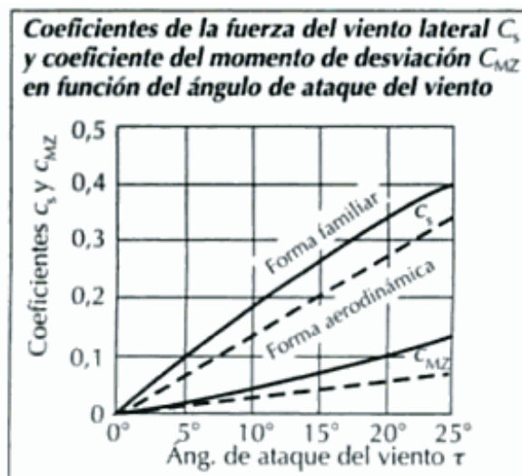
Figura 5. 28 Coeficientes de la fuerza lateral del viento y del momento de desviación de la dirección para vehículos de tipo familiar y aerodinámicos.
