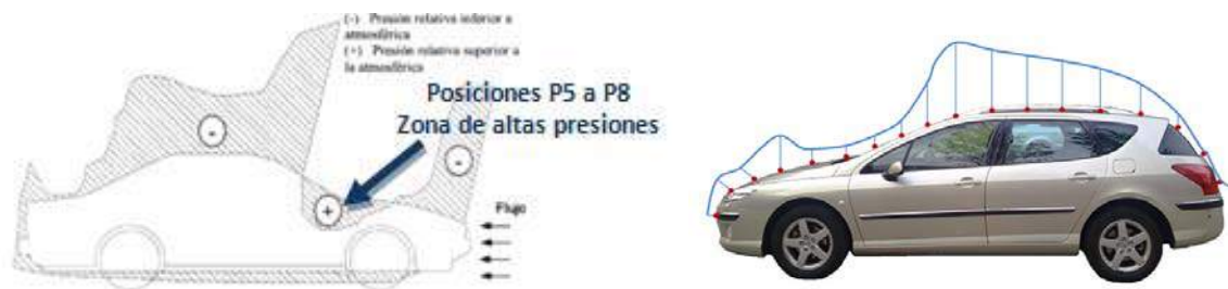
Figura 5. 11 Zona de altas presiones correspondiente con una disminución de velocidad del flujo en la zona del parabrisas.
