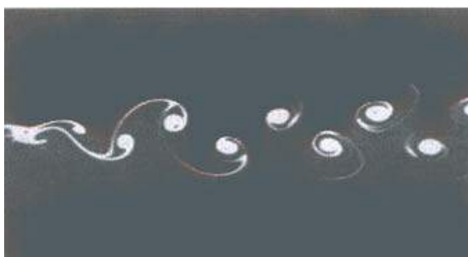
Figura 5. 22 Vórtices generados en el seno de un flujo laminar debido a una perturbación.
