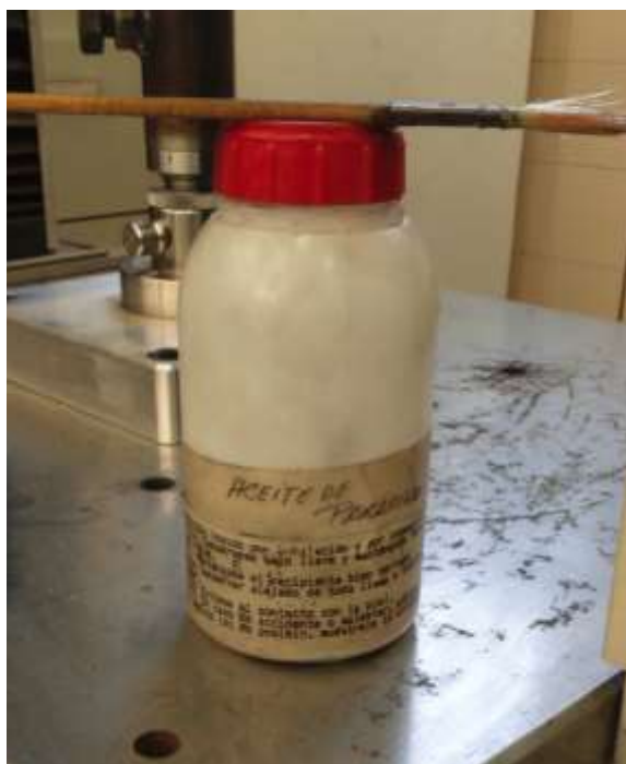
Figura 4-12. Aceite de parafina utilizado como lubricante para la plastilina
