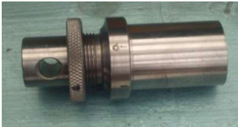
Figura 3-6. Macho interior terminado y con su tuerca de apriete
