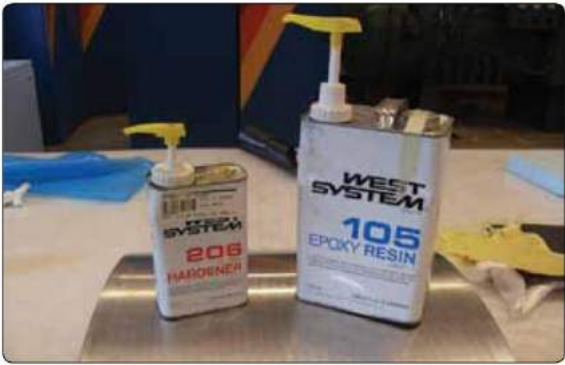
Ilustración 11: Latas de Resina epoxy con dispensador para apilados manuales (hand-lay up) (Federal Aviation Administration, s.f.)
