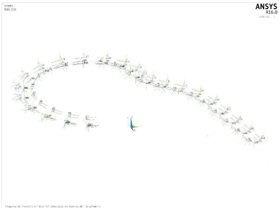
Ilustración 73: Sistemas de Coordenadas Locales creados para la creación de la geometría y mallado de elementos
