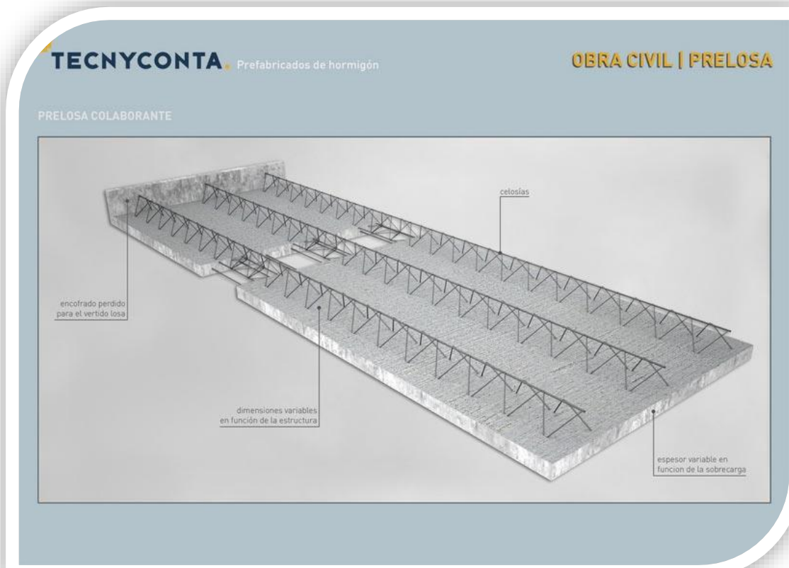
Ilustración 92: Prelosa colaborante de la empresa Tecnyconta, elegida para el proyecto (Tecnyconta, 2015)
