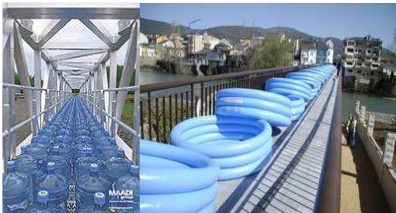
Ilustración 165: Botellas de agua y piscinas infantiles rellenas de agua como prueba de carga en pasarelas peatonales.
