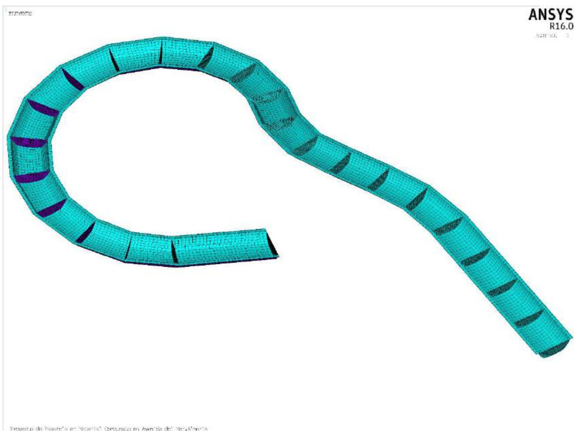
Ilustración 79: Mallado de la viga
