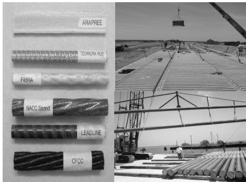
Ilustración 38: Tendones de pretensado de FRP nipones (izqda.). Colocación de encofrados para el tablero de un puente (superior drcha.) y pilotes de FRP (inferior drcha.)
