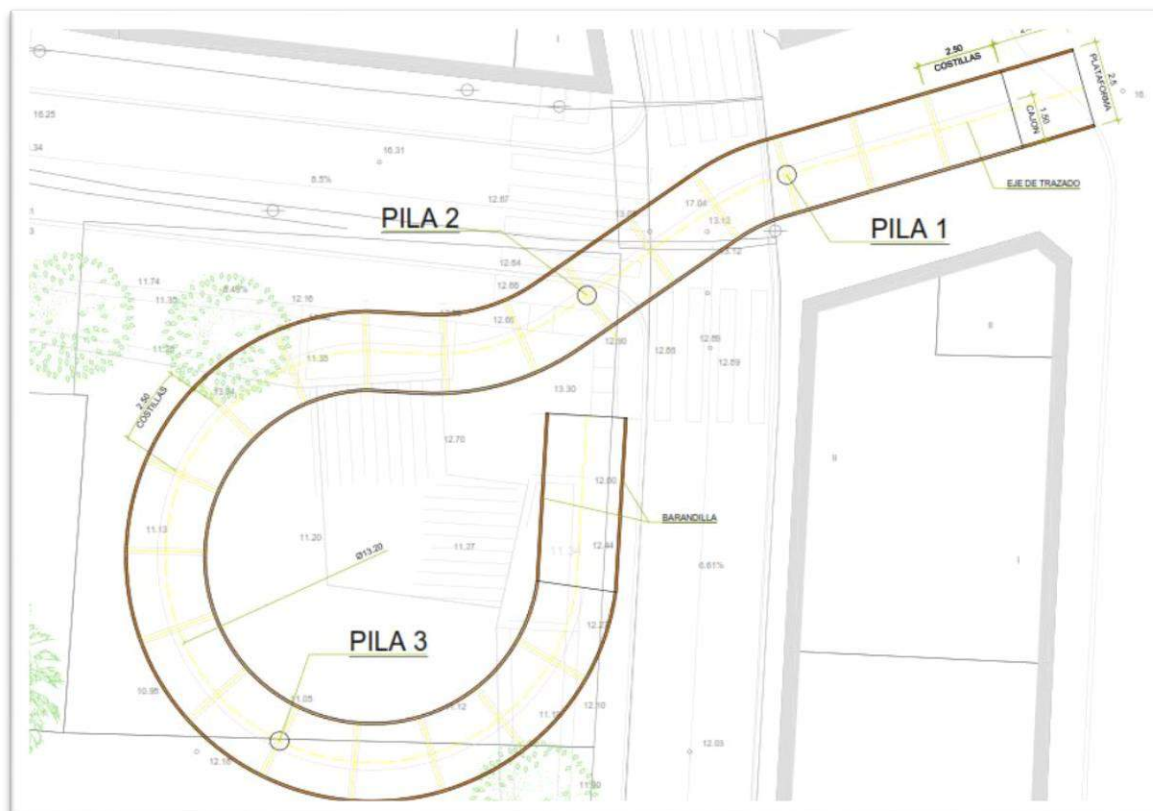
Ilustración 57: Esquema del posicionado de las pilas
