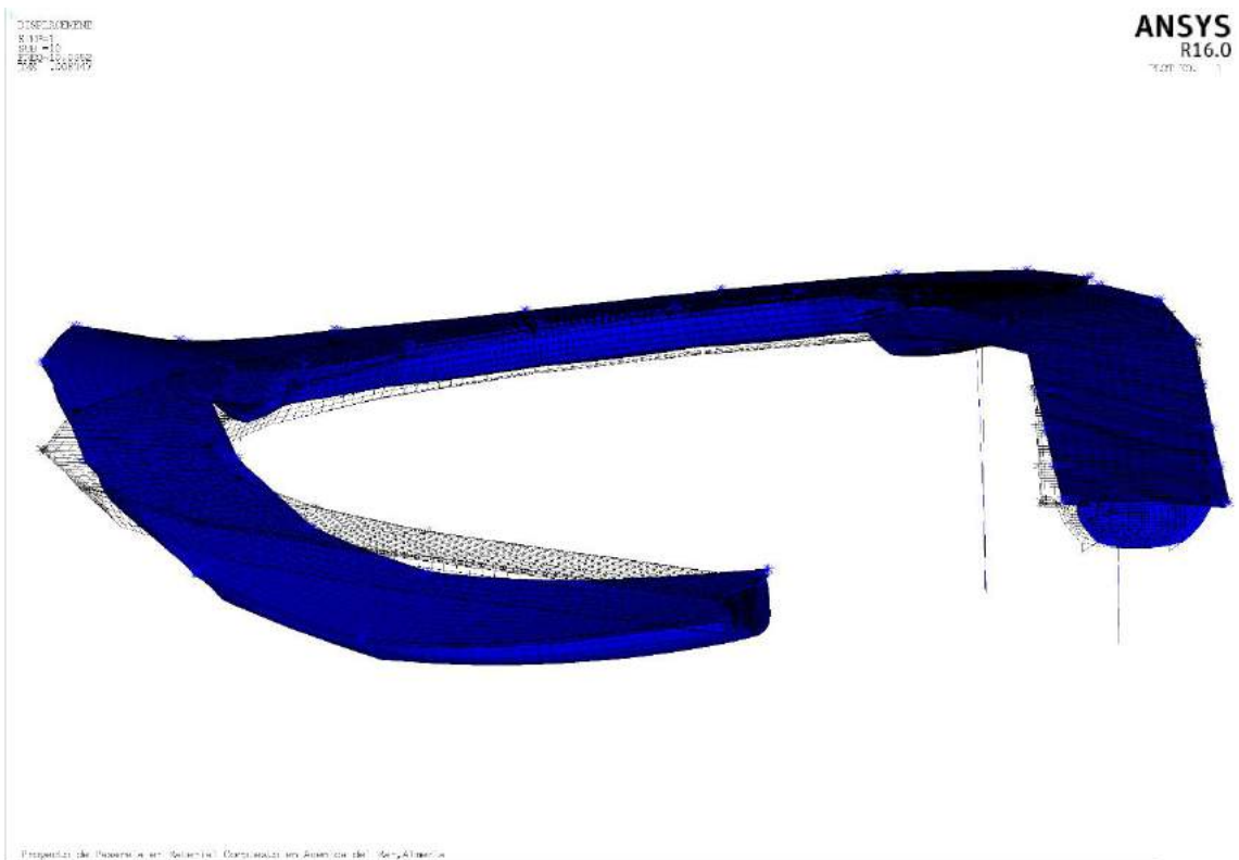
Ilustración 142: Modo de vibración (vertical) para la décima frecuencia natural (10.06Hz)
