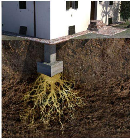
Distribución de resina en suelo cohesivo GEOSEC
