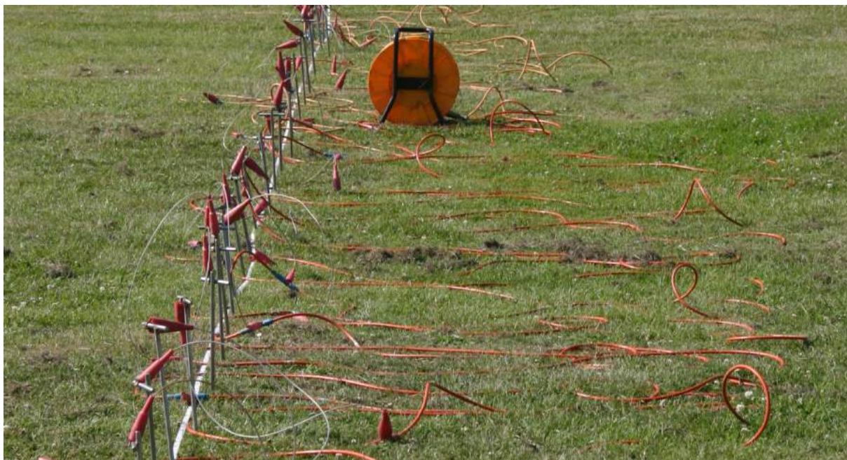
Disposición de electrodos en el terreno
