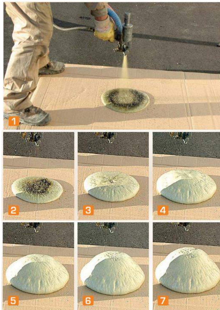
Fases de reacción resina expansiva para recalces RESINA GEOPLUS URETEK
