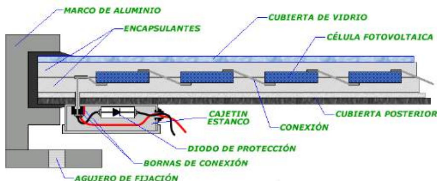
Figura 3.23: Elementos de un módulo fotovoltaico.
