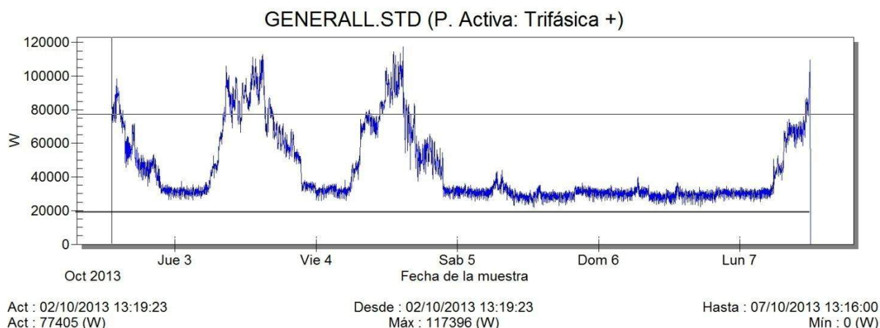
Figura 3.21: Perfil de carga Edificio de Oficinas
