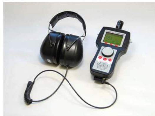
Figura 10-3. Detector de fugas por ultrasonido [17]
