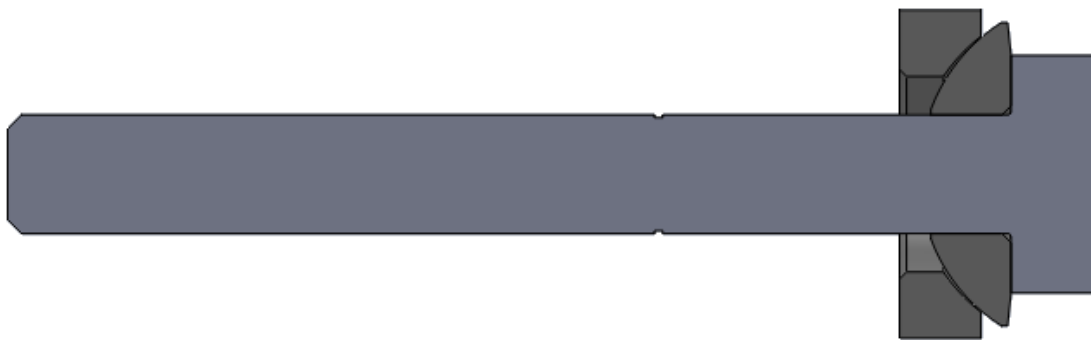
Figura 30: Sección del conjunto vástago y rótula axial
