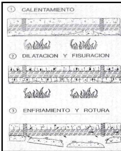
Fig. 5. 19 Efecto del calor sobre una estructura
