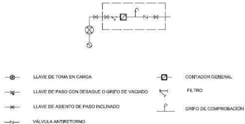
Figura 1. Esquema instalación fontanería
