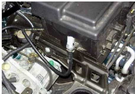
Figura 52. Ejemplo instalación del Sensor MAP. (Fuente: BRC Gas Equipment)
