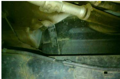
Figura 13. Sujeción trasera izquierda del depósito de gasolina Ford Fusion. (Fuente: Mas Motor Canarias)
