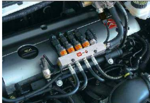
Figura 51. Ejemplo instalación Rail con inyectores BRC. (Fuente: BRC Gas Equipment)
