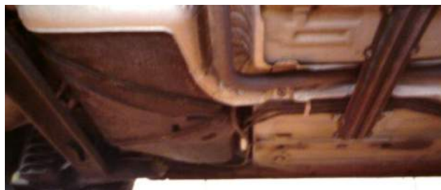
Figura 12. Depósito de gasolina junto sistema de escape. Ford Fusion. (Fuente: Mas Motor Canarias)
