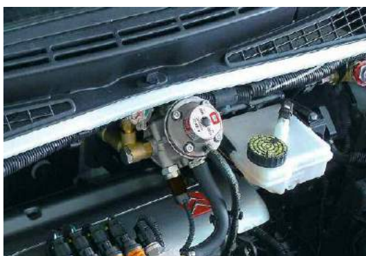
Figura 48. Reductor Zenith GNC. Ejemplo de posición de montaje. (Fuente: BRC Gas Equipment)
