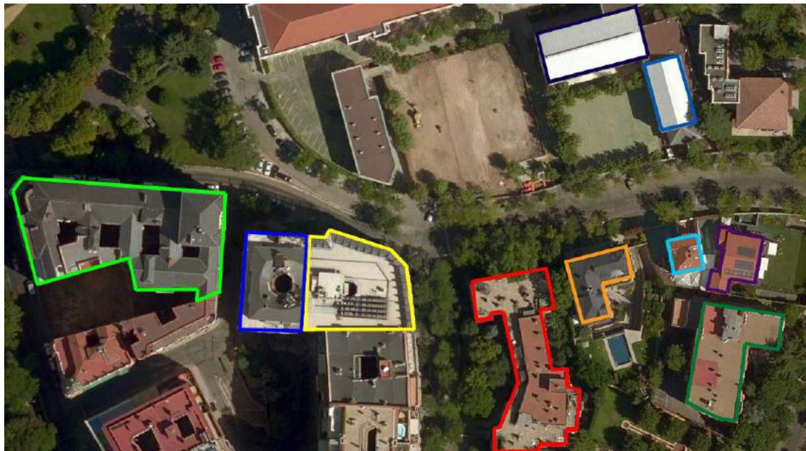
Fig. 56 Edificios cuya sombra afecta a la instalación fotovoltaica
