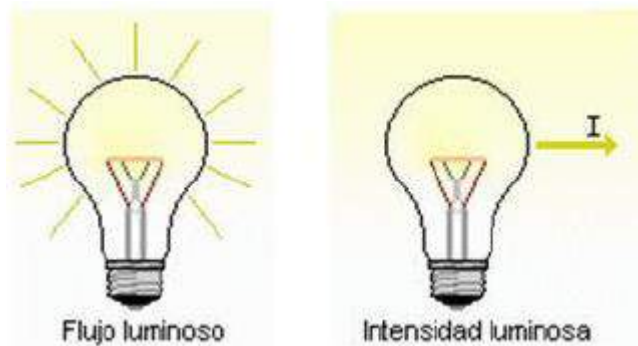
Figura 1-1. Diferencia entre flujo e Intensidad luminosa [19]
