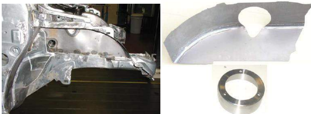
Figura 56: Paso de rueda delantero montado (izquierda) y piezas a instalar (derecha)
