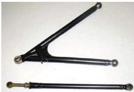
Figura 59: Trapecio trasero y tirante de regulación de convergencia
