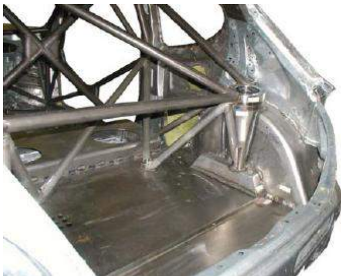
Figura 13: Vista de la carrocería con sus modificaciones realizadas y la jaula instalada
