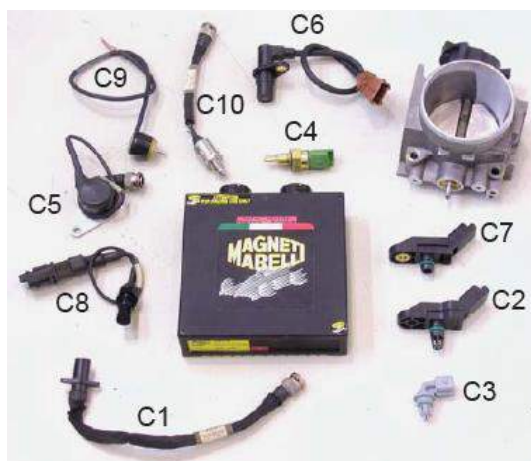
Figura 5: Componentes de la electrónica instalada: C1 sensor de posición del cigueñal, C2 sensor de presión de entrada de aire, C3 sensor de temperatura de aire, C4 sensor de temperatura de agua, C5 sensor de posición del acelerador, C6 sensor de posición de los árboles de levas, C7 sensor de presión atmosférica, C8 swich de la caja de velocidades, C9 indicador de la marcha insertada, C10 sensor de presión de combustible.
