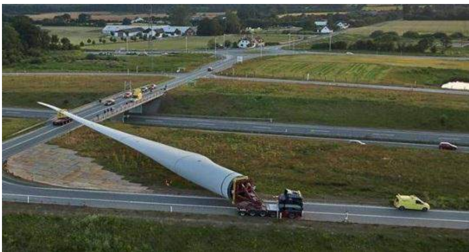
Ilustración 23. Vista del transporte de un elemento del aerogenerador (gran radio de curvatura)
