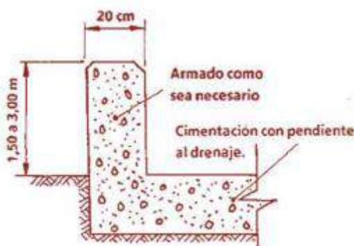
Ilustración 30 Esquema del muro exterior del cubeto
