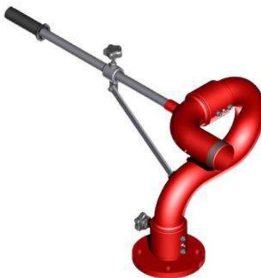
Ilustración 14 Esquema 3D de monitor espuma
