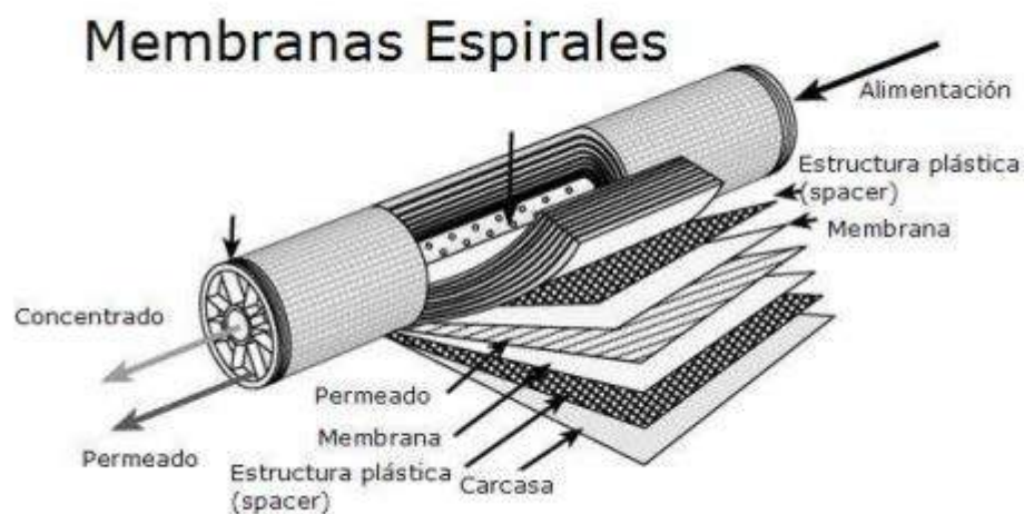
Ilustración 13. Membrana de módulo en espiral
