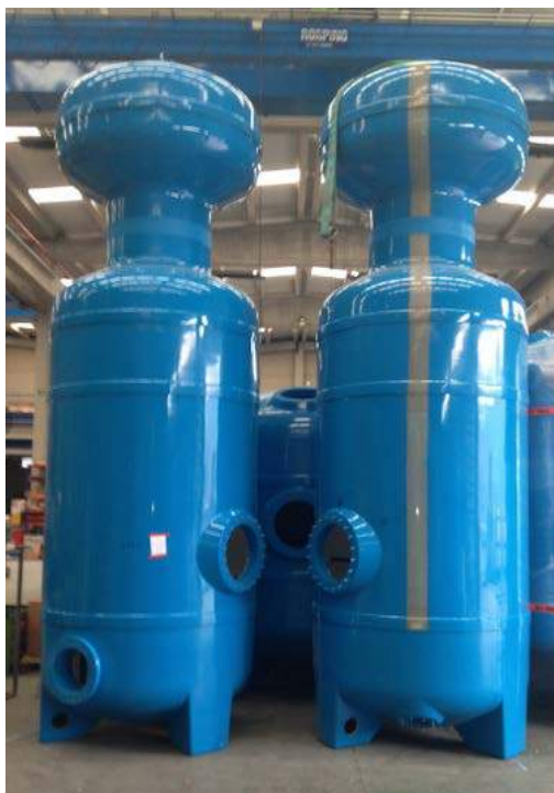
Ilustración 24. Disolvedores de CO2 a baja presión (Fabricante Drintec).
