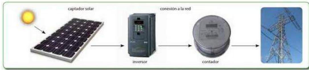
Figura 3.1: Esquema de una instalación fotovoltaica con conexión monofásica a la red.
