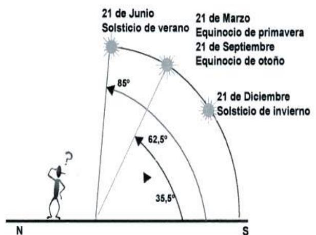
Figura 1.4: Altura del Sol en diferentes estaciones del año (N-S). (Fuente: Méndez, Cuervo, & S.A.U. (2008))
