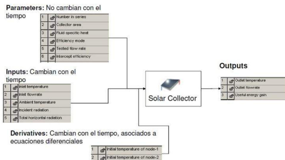
Figura 27. Componente “Solar Collector” (TYPE 1) en TRNSYS.
