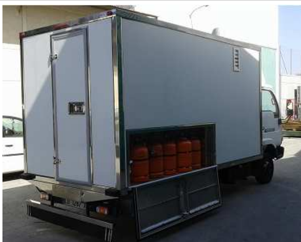
Foto 7. Vista lateral derecho del vehículo Emplazamiento para bombonas de propano
