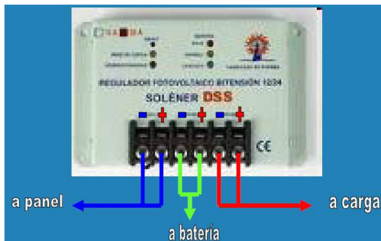
Fig.4.16. Conexión regulador
