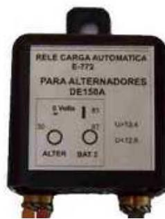
El funcionamiento del relé separador es muy simple. Así, cuando el alternador del vehículo genera una tensión igual o superior a los 13,5 V, el relé conecta la batería auxiliar al alternador, manteniendo esta conexión siempre que la tensión que suministre el alternador quede por encima de una tensión de 12,6 V. Por debajo de los 12,6 V o cuando el motor del vehículo se para, el relé separador se desconecta para evitar la descarga de la batería principal.
