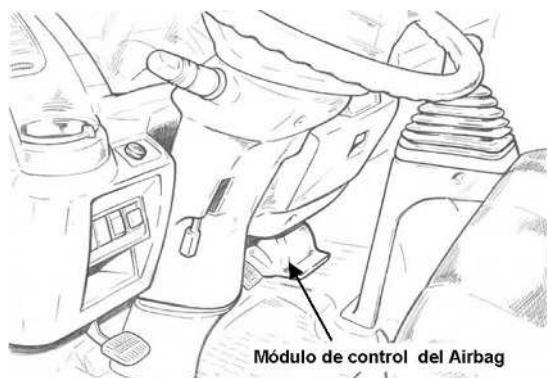
Tampoco se puede situar otros componentes del vehículo alrededor de la zona donde se sitúa el módulo de control y el sensor.
