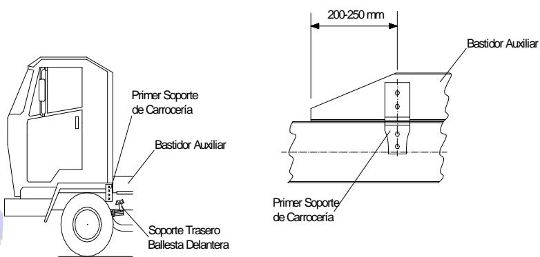
Es muy importante acatar esta recomendación, especialmente en el caso de carrocerías/equipamientos con cargas concentradas en la parte posterior de la cabina (p. ej. grúas) a fin de evitar, de esta manera, los problemas derivados de las vibraciones y poder garantizar una mejor estabilidad.
