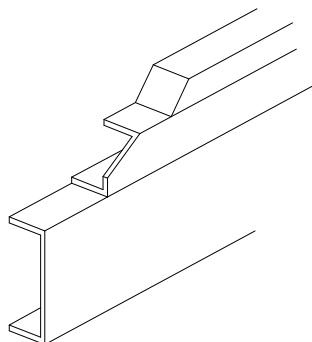
Cuando se precise que el falso bastidor se adapte elásticamente al bastidor del vehículo, se utilizarán preferentemente perfiles en "U" plegados o perfiles en "U" comerciales específicos para la construcción de vehículos (no utilizar perfiles laminados usados para construcción).
