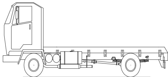
La parte delantera del larguero deberá prolongarse lo máximo posible, como mínimo hasta el soporte trasero de los muelles delanteros, o bien entre 200-250mm por delante del primer soporte de la carrocería, en el caso de suspensión independiente.
