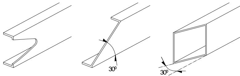
Cuando algún componente del vehículo impida el paso de los largueros en toda su sección, estos podrán rebajarse como indica la figura siguiente. No obstante, se tendrá especial cuidado en comprobar la sección mínima cuando se prevean momentos de flexión elevados en la parte delantera, por lo que se recomienda realizar un estudio para obtener los diagramas de esfuerzos en la zona y comprobar que con la sección disponible no se rebaja el límite de seguridad mínimo exigible.
