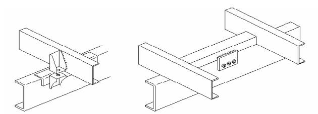
Los tornillos empleados en la unión de los soportes deberán ser de alta resistencia, calidad 8.8, montados sin holguras, tuercas autoblocantes de seguridad calidad 10 y arandelas planas en ambos lados con dureza mínima 200 HB usadas debajo de las cabezas de los tornillos y de las tuercas.
