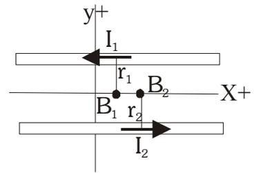
Calculamos los módulos de los campos producidos por cada conductor en el punto medio entre los cables. La dirección y sentido puede verse en el dibujo (punto: hacia fuera, aspa: hacia dentro). Asignamos luego el vector unitario correspondiente a cada campo.
