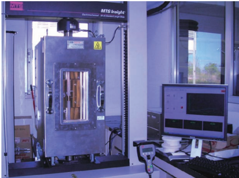
Figura 1.7. Ensayo mecánico de resistencia al desgarro
