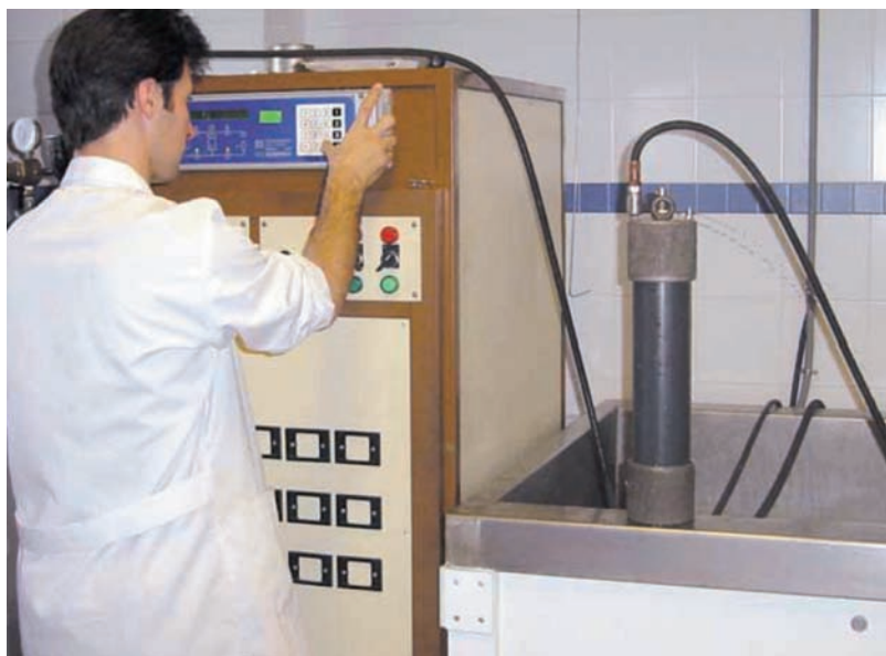
Figura 1.9. Ensayo de estanquidad bajo presión en probeta de PVC
