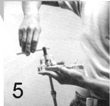
Fig. 3.8. Apriete del cono sobre la parte que sobresale del tubo hasta el asiento en el chaflán
