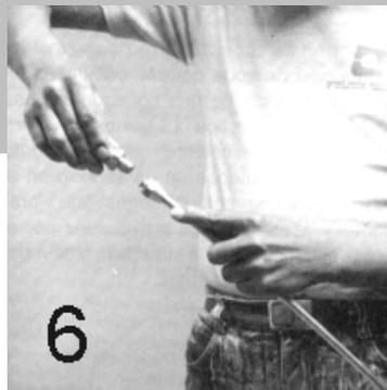
Fig. 3.9. Colocación de la conexión y apriete de la tuerca cónica
