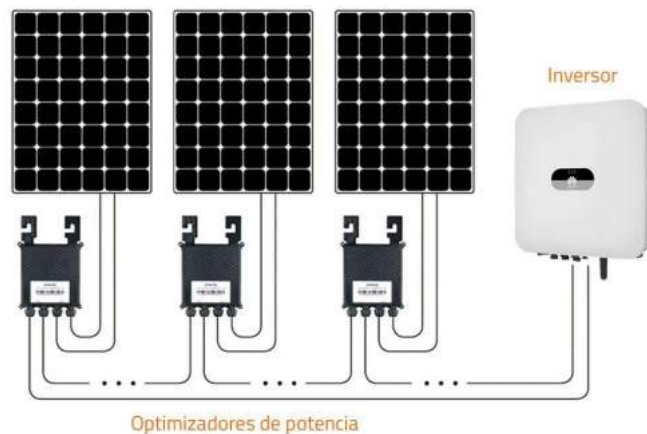
Figura 26: Inversor con optimizadores de potencia.
