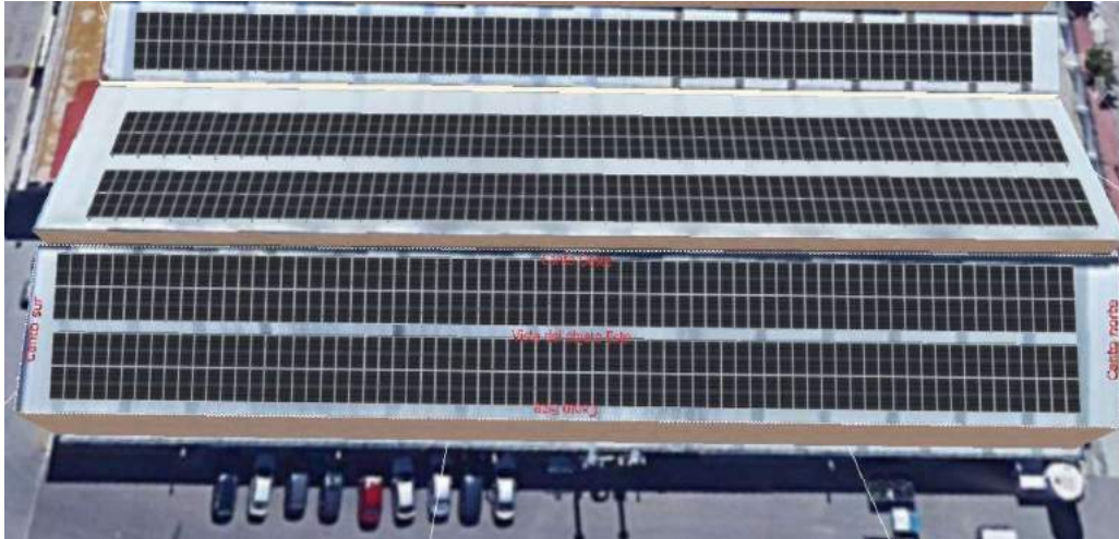
Figura 41: Distribución de los módulos en cubierta.
