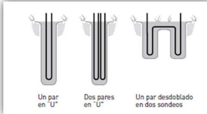
Ilustración 31: Tipos de instalación de tubos captadores verticales en sondas geotérmicas.
