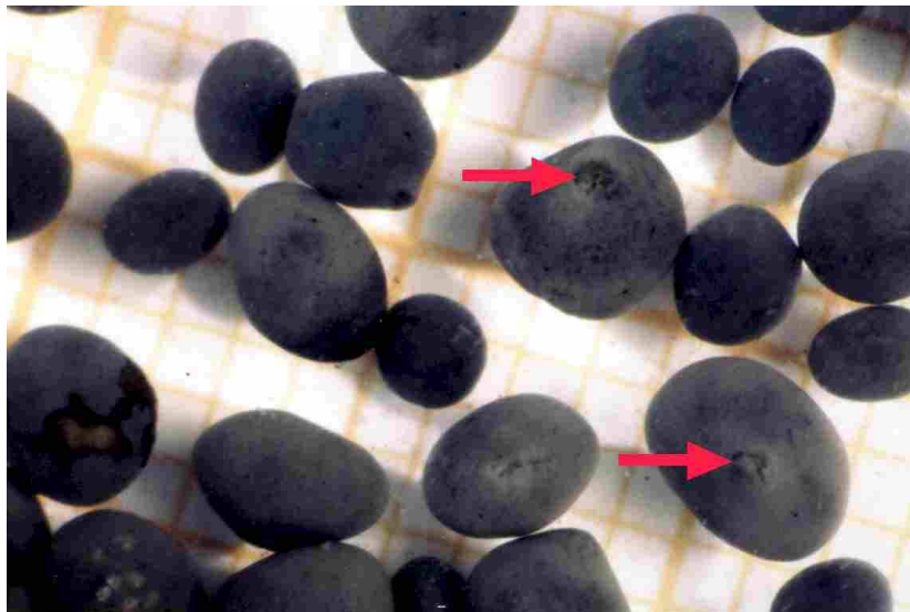
Figura 22. Gránulos procedentes del tratamiento de aguas residuales. El fondo es un papel milimetrado apreciándose así el tamaño de partícula. Las flechas rojas marcan los poros de salida del biogás de las capas internas de los gránulos. 28
