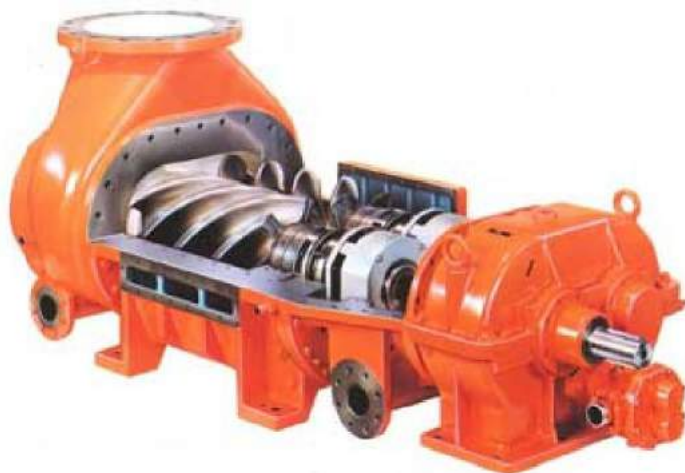
Figura 40: Compresor de Tornillo abierto.
