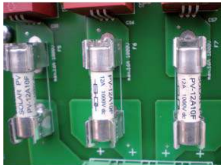
Fusibles en la caja de conexión
