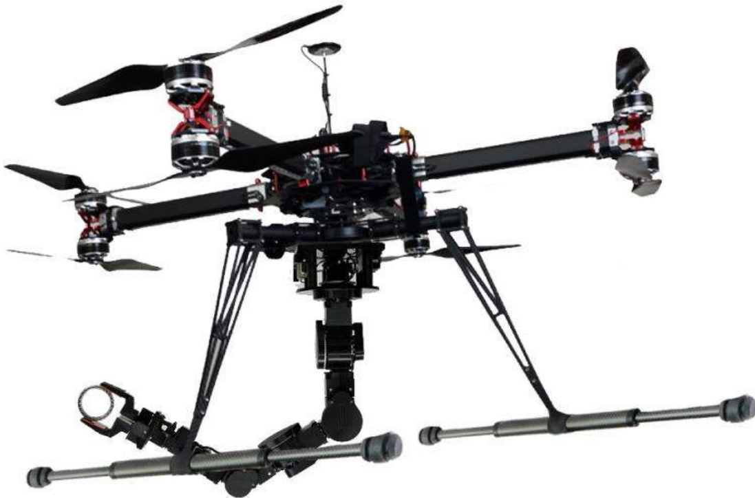
Quadrotor con brazo robótico Cyton Gamma 1500 acoplado en su base
